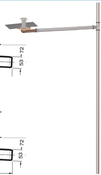
**System-Variante mit Siebeinheit für obere Balkone und mit Wärmedämmung**
